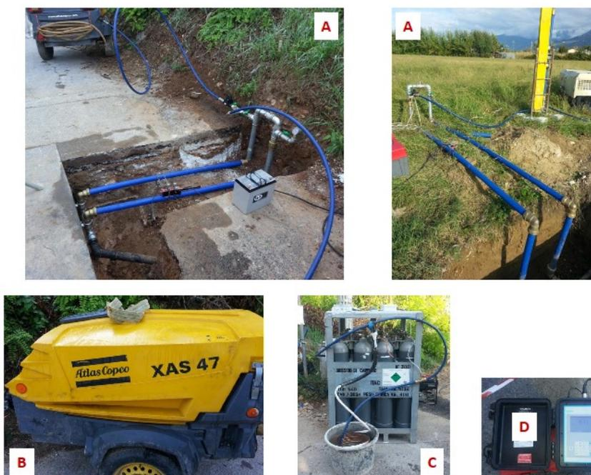
**Figura 1.** Attrezzature allestite al punto di immissione della miscela acqua-gas. A: punto di immissione; B: compressore d'aria; C: pacco bombole; D: misuratore di portata dell'acqua.
