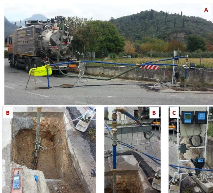
**Figura 2.** Attrezzature allestite al punto di uscita dell'effluente della condotta trattata. A: allaccio temporaneo alla fognatura urbana e, in *by-pass* a quest'ultima, ad un automezzo abilitato alle operazioni di spurgo; B: dettaglio della connessione temporanea; C: misuratore di torbidità.
